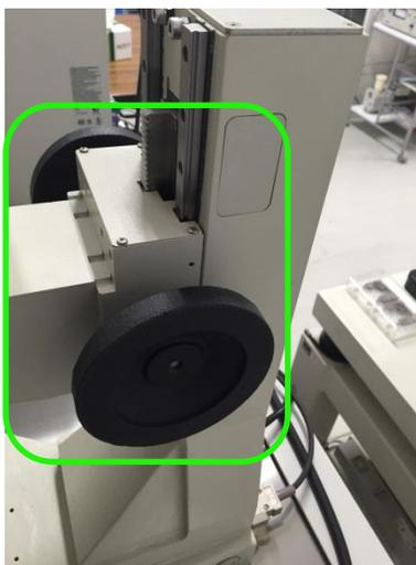
大きな試料を扱う場合は顕微鏡後方にある顕微鏡鏡基Z軸を調整して接眼レンズとステージの距離を広げられます
