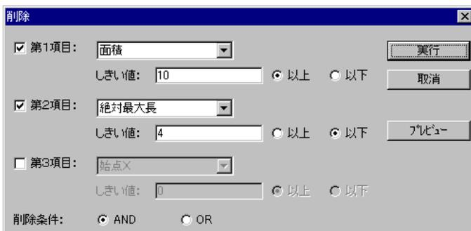
⑥ タブの「前処理」→「削除」を選択し、削除ウィンドウで「第一項目」の欄を「面積」、しきい値を「10」「以下」にして、「第二項目」の欄を「絶対最大値」、「しきい値」を「4」、「以下」にして実行します
