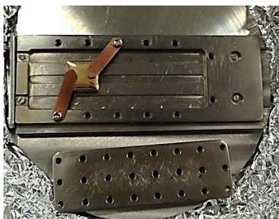
少し高さがある試料は底部を外して固定します
