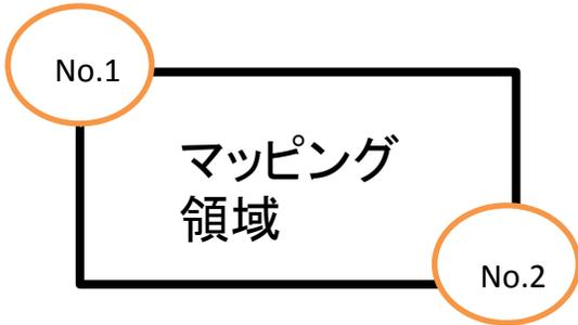
ステージコントローラーでimage像を取得したい試料の範囲の、左上のステージ位置をmemoryNo.1に、右下のステージ位置をmemoryNo.2に記録させます
