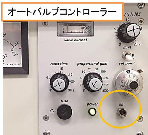
オートバルブコントローラーの電源をONにします。バルブが閉められ始め、イオン化室真空計の値が一旦下がります
