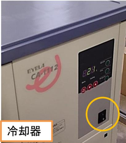
始めに**冷却器**の電源を入れます。温度表示が出れば問題ありません。次に**SPEC**ボタンと**X-R**ボタンを押して、点灯させます
