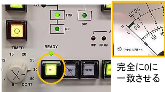
準備室の真空を十分に引いた状態でV1ボタンを押してバルブ解放。導入棒の黒いリングを手前に押して試料を分析室に導入します。のぞき窓からホルダーとステージを確認しながら入れて下さい。奥まで入れたらリングを回して「OPEN」にし、黒いリングを後ろまで一番引き抜き、もう一度V1を押してバルブを閉めます
