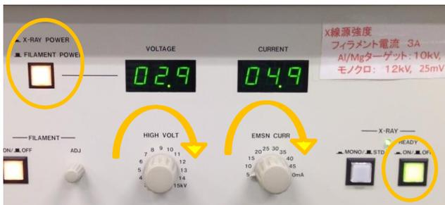
次にディスプレイの表示をX-RAY POWERに切り替えて、X-RAYの電源をONにします。3kV,5mAが印加されます。電圧・電流のつまみを3分ごとに1刻みずつ順番に回し、10kV,10mAまで上げていきます
