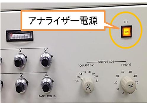
最後にAnalyzerの電源をONにしますよく忘れるので注意
