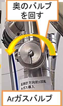
イオン化室の真空計でAVCボタンを押します。左画のArガスバルブをゆっくり開きます。6時を指すマーカから反時計回りにおよそ一回転させます。イオン化室ガス圧が上がります
