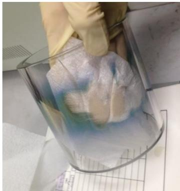
蓋部の弁を傾かせてベルジャー内を大気に戻し、試料を回収します。ベルジャーガラスの内側をエタノールかアセトンで洗浄し、元の状態に戻して終了です
