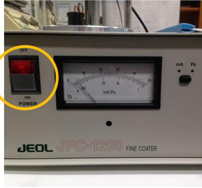
蓋をきちんと閉めて本体の電源をONにします。真空を引き始めます
