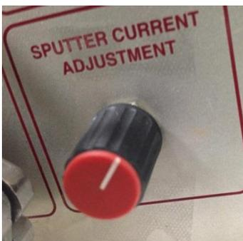
サンプルの形状が不定形(板状ではない)の場合、真空度を15Paぐらいでスパッターするとコーティングが全体に回りこんで導電性が向上します。また、コーティングしたターゲット粒子を出来るだけ微小に留めたい(ダマにしたくない)場合は真空度は8Paでスパッター電流値を小さくして(5mAぐらい)ゆっくりコーティングさせましょう
