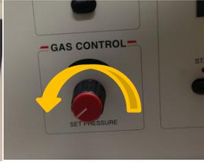
十分真空に引いたらGAS CONTROLを7時の方向ぐらいまで反時計回りに回して真空度を8Paに調整します
