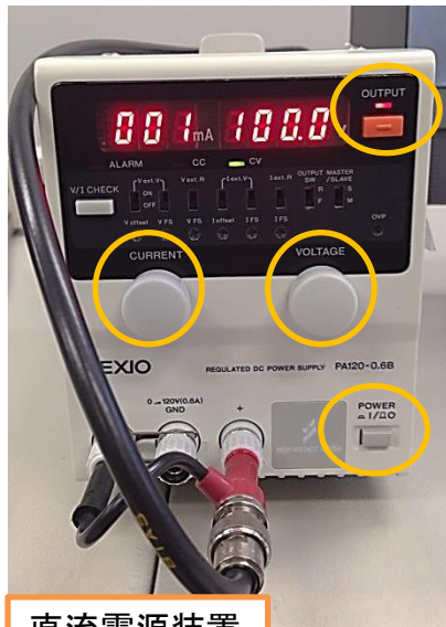
直流電源装置
