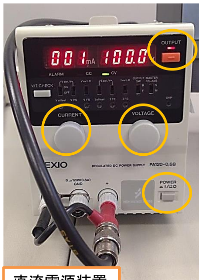
直流電源装置
