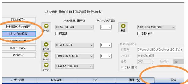
ソフトウェア下の「設定」タブを選択し、左の「スキャン・自動保存」でスキャンスピードの変更が行えます。スロースキャンだと帯電現象がキツイ、素早くたくさん写真と撮りたい、信号を加算して解像度を上げたい、などの場合に設定を調整して下さい
