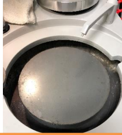
研磨紙用接着板 マグネットで付きます
