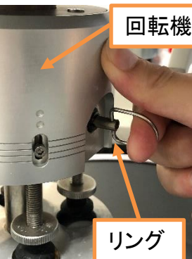
固定レバー 少しキツめに固 定して下さい
