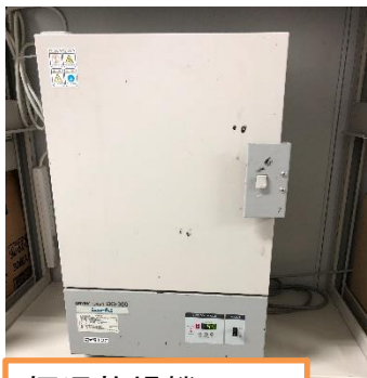
恒温乾燥機 電源On温度50度設定
