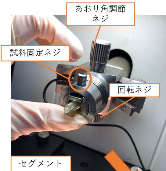
トリミングしたサンプルを試料を固定するセグメントに入れます
