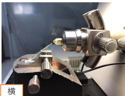
サンプルとナイフの刃が両方見える倍率まで上げ、接眼レンズで見ながらコントローラのAPPROACHのCOARSEレバーでサンプルと刃が当たるぎりぎりまで近づけます
