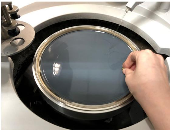
取り出したサンプルの先端を鉛筆の芯のように尖らせるために回転研磨機で四面を削ります
