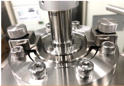
トランスファーベッセル 取り付け
