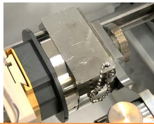
観察窓カバーを付ける際にチェーンが絡まないように注意
