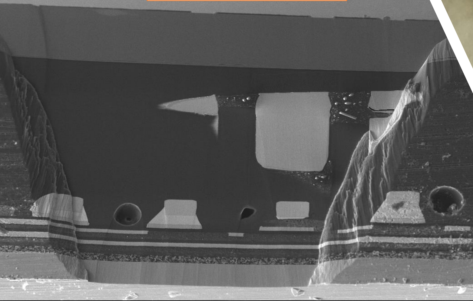
ミリング箇所断面SEM像 上部はSiウェハ
