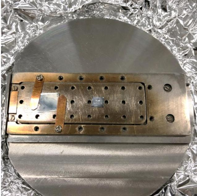
CaO粉体について、2つの固定方法を試して比較してみました。1つはカーボンテープに粉体を振りかけて接着させたもの、1つはインジウム箔に粉体を載せ、アルミホイルでカバーして油圧プレス機で埋め込み、アルミホイルを剥がすという方法です。
