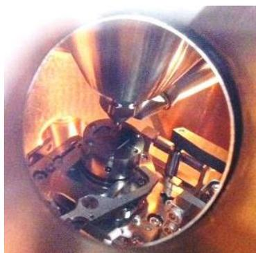
分析室を覗きながら、マグネットリングを押し出して試料をステージに入れます。マグネットリングを「OPEN」へ回し、フックが外れたのを確認してからマグネットリングを後退させます
