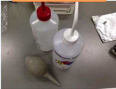
オージェ分析ではコンタミ(試料汚染)が分析に強く影響を与えます。出来るだけ清浄な表面を用意して下さい
