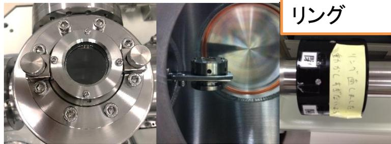
導入室内のフォークにホルダーの**上の溝**を差し込んで、マグネットリングを回して「**CLOSE**」を上にし
