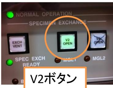
マグネットリングが後ろ端まで来ているのを確認し、V2ボタンを押してV2バルブを開けます
