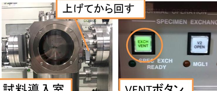
試料導入室ドアのロックを外します。**VENTボタン**を押して導入室を大気に戻します
