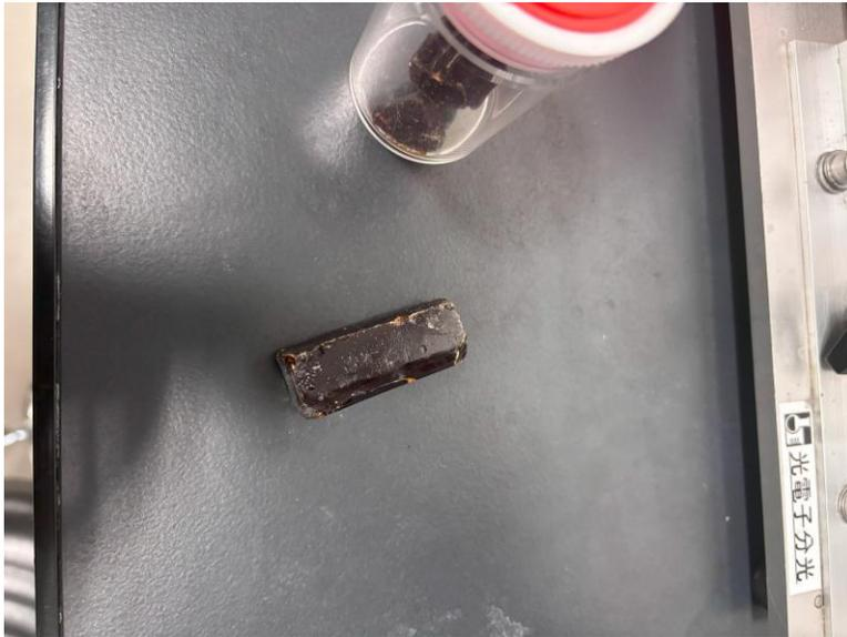
主にハンディラップで研磨する試料を、スペーサーというガラスの台座に固定する時に使用するワックスです。熱で溶かして塗ります。臭いです。
