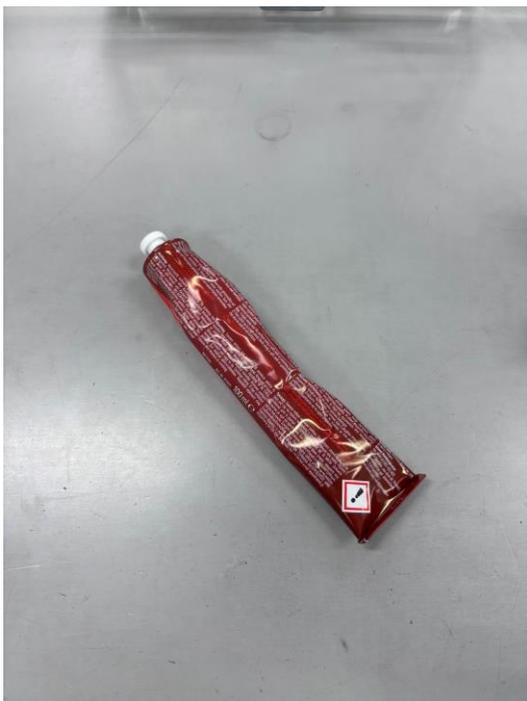
ペースト状の研磨材です。主に真空装置部品の汚れを落とすのに使用します。
