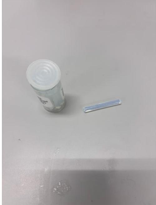
CP用の試料を試料台などにマウンティングする用のワックスです。透明です。試料台をヒーターで温めてワックスを少し塗って、試料を設置して冷やすと固定されます。
