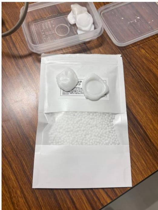
お湯の温度(60度以上)で柔らかくなる樹脂粘土です。試料面の水平出しをする際に使います。この粘土を試料裏面に柔らかい状態で載せて、ハンドプレスにかけて水平出しします。
