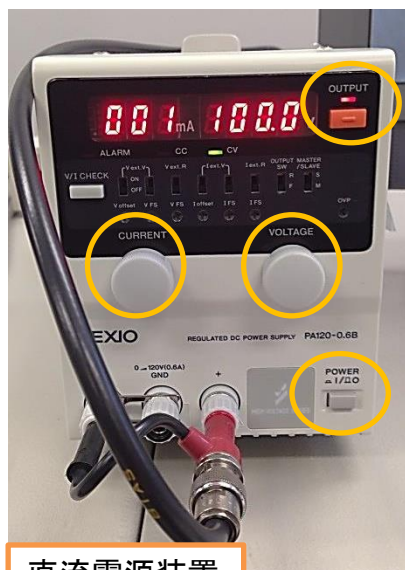
直流電源装置
