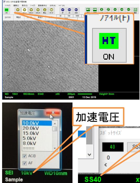
加速電圧 : 0.5kV~30.0kV
