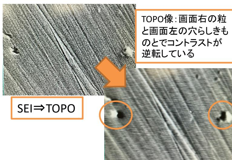
二次電子像(SEI)の他、反射電子検出器による組成像(COMPO)、凹凸像(TOPO)、立体像(COMPO+TOPO)を観察出来ます。変更する場合は左図のように信号を選択。反射電子像を見る場合は高電圧・高電流推奨
