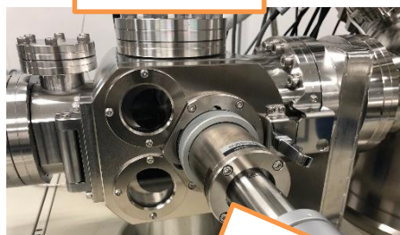
真空引きの際、少しベッセル本体を押し込んで下さい
