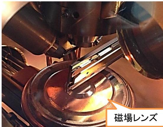
Angle ResolvedではステージのTiltをアナライザー軸に対して徐々に傾けながらスペクトルを取得して、非破壊で試料の深さ方向のプロファイルを取得出来ます
