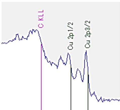
スペクトル上にラインが現れます。ピークにドラッグして当てるとSuggested Peaksに想定される元素一覧が表示されます。Elementから元素を選択してAddを押すと元素名がスタンプされます。元素によってはChemical Shiftの一覧も載っており、これもスタンプ出来ます。最後にOKをクリックするとスタンプが残ります
