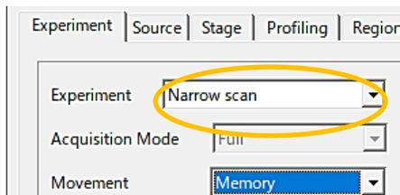
**Wide scan**後、定量や化学状態分析の為、分解能の高いモードで各元素のメインピーク付近のスペクトルを取得します。**Experiment**で**Narrow scan**を選択します
