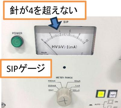
Arガスバルブをさらに微調整し、 $10.0 \times 10^{-2}$  Paで安定するようにします。開けていく際、真空計の下にあるSIPゲージの針を確認し、4を超えないように開けてください。針が4を超える場合はバルブを閉じ、またゆっくり開けながら $10.0 \times 10^{-2}$  Paを目指してください。少し時間を置いて、値が上がるようなら締めて調整して下さい
