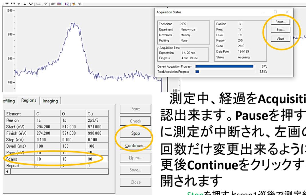
測定中、経過をAcquisition Statusで確認出来ます。Pauseを押すとscan1巡後に測定が中断され、左画のようにScans回数だけ変更出来るようになります。変更後Continueをクリックすると測定が再開されます
