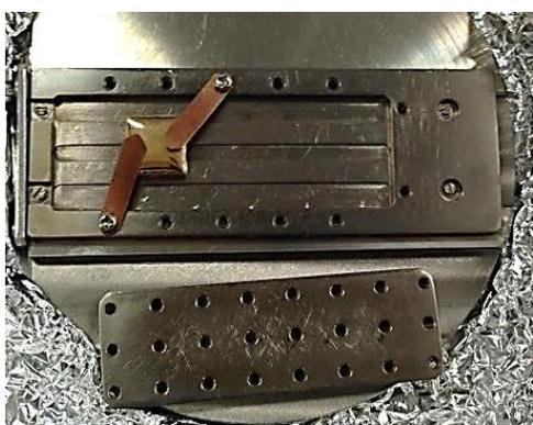
2mm以上厚みがある試料は底板を外して固定
