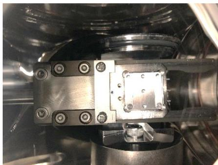
ベッセル内の真空が引いたら開閉ノブを全開にします。黒いリングを操作してホルダーを受け取り、ベッセルを閉めます(完全には閉めず、ちょっとだけ口を開けとく)。試料準備室の真空が十分に引いたらV1を開けて分析室にホルダーを導入。V1を閉める。
