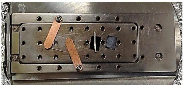
留め金固定は必ず両脇に。固定後はホルダーを逆さにしてしっかり固定しているか確認して下さい。X線源と留め金&試料の位置関係に注意
