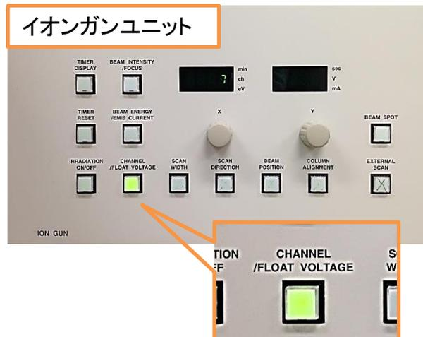
イオンガンユニットで Channel/float voltage ボタンを押して点灯させ、ディスプレイに表示された番号が「7」であることを確認
