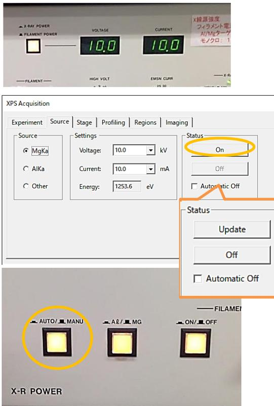
SPECSURFのXPS AcquisitionからSourceタブを選択。X線源の種類、電圧電流値を入力後、Statusで「On」をクリック
