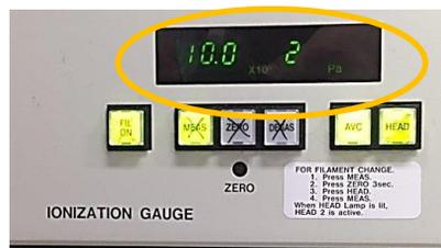
オートバルブコントローラーの電源をONにします。バルブが締まり、イオン化室真空計の値が一旦下がります
