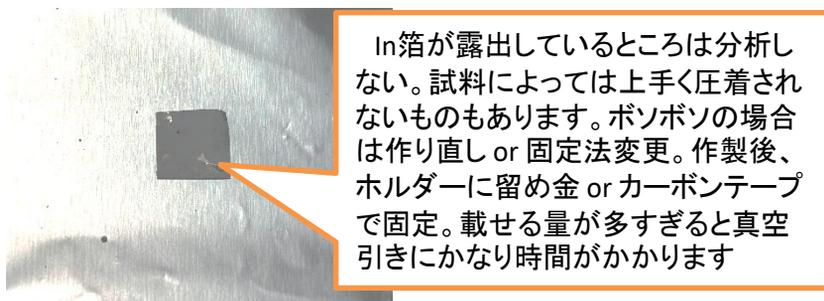
In箔が露出しているところは分析しない。試料によっては上手く圧着されないものもあります。ボソボソの場合は作り直し or 固定法変更。作製後、ホルダーに留め金 or カーボンテープで固定。載せる量が多すぎると真空引きにかなり時間がかかります
