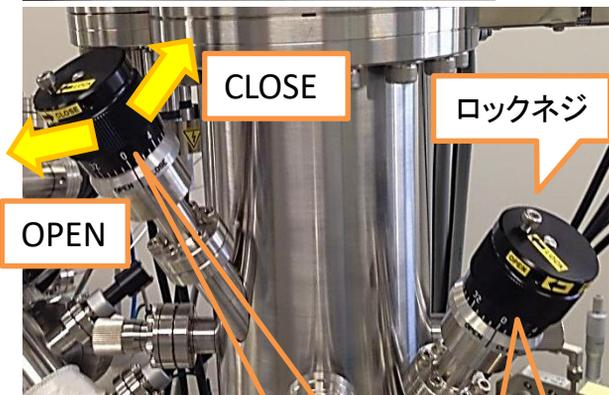
測定範囲の設定は左画の2つの絞りで切り替えます。ロックネジを緩めて、測定範囲を狭める場合はCLOSE方向、広げる場合はOPEN方向に絞りを回して左表の数値に合わせます。36はOPEN方向に一周分開いて0に合わせます
