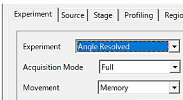
ExperimentタブでAngle Resolvedを選択し、Profilingタブでステージの傾ける角度の設定を行います。左画の設定だと $0^{\circ}$  から $80^{\circ}$  まで $5^{\circ}$  ずつ傾けながら各レベルのスペクトルを取得します。残りの設定は「Wide Scan」、「Narrow Scan」を参照
