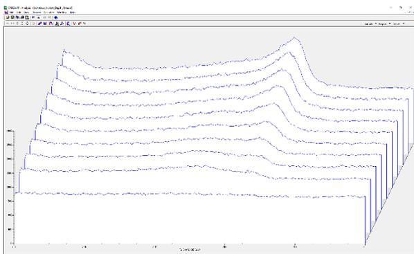
Depth ProfileではAr<sup>+</sup>エッチングと測定を交互に繰り返す事によって、試料の深さ方向のプロファイルを取得出来ます
