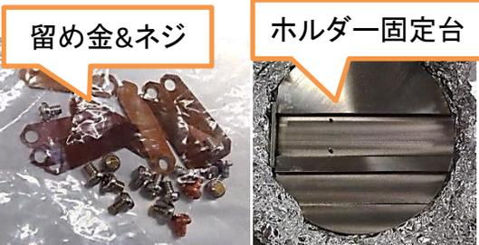
装置の立ち上げ前に試料をホルダーにセットします。ホルダー類は真空デシケーターに保管されています。通常の試料であればノーマルホルダーを利用
