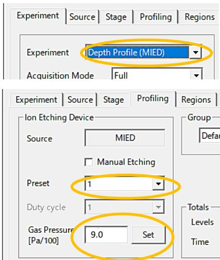
XPS AcquisitionのExperimentタブからExperimentを「Depth Profile」に切り替え後、Profilingタブを選択します。Presetに使用するchannel番号、Pressureに上記の表の値を入力し、Setをクリック。次第にガスバルブが緩み、ガス圧が指定値付近で落ち着けばAr+エッチングの準備は終了
