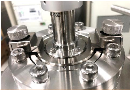
トランスファーベッセル 取り付け
